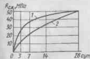
Рис. 9. Темпы твердения БТЦ (1) и обычного портландцемента (2) марок 500
