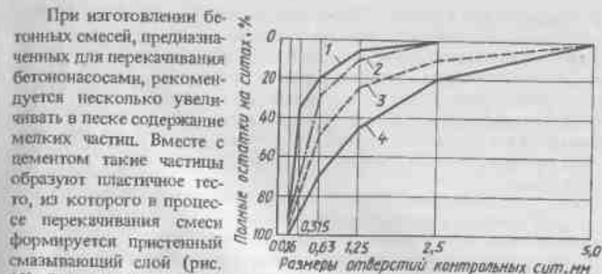
Рис. 11. Кривые зернового состава песка: 1 — допустимая нижняя граница крупности песка ( M_k = 1,5 ), 2 — рекомендуемая нижняя граница крупности для бетонов класса В15 и выше ( M_k = 2 ), 3 — рекомендуемая нижняя граница крупности для бетонов класса В25 и выше ( M_k = 2,5 ), 4 — допустимая верхняя граница крупности песков ( M_k = 3,25 )
